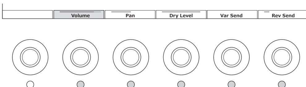
Utilizzare queste manopole per controllare la riga dei parametri selezionata mostrata nel display Main. Le manopole con i nomi dei parametri visualizzati nella parte inferiore del display Main con le relative spie degli indicatori accese possono essere usate per modificare le impostazioni dei parametri.
