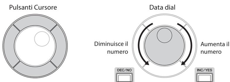
Spostando una posizione del cursore su una riga diversa dei parametri mediante i pulsanti su e giù, è possibile controllare un diverso set di parametri utilizzando le manopole del display
