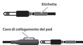
\* Inserite saldamente la spina controllando che sia infilata completamente.
