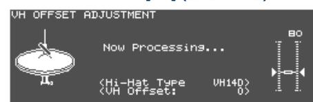
Il parametro "VH Offset" viene impostato automaticamente (dopo circa 3 secondi).
