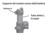
2. Usate il bullone del supporto del modulo sonoro della batteria per fissarlo come nell'illustrazione.
