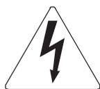
Questo simbolo indica che all'interno dell'apparecchio è presente un'alta tensione non isolata, sufficientemente alta da causare il rischio di shock elettrico alle persone
