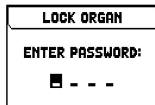
Per sbloccare l'organo selezionare il campo a display UNLOCK ORGAN nel menu UTILITY e impostare la password corretta utilizzando i pulsanti sopra descritti. Se la password è corretta verrà visualizzato il messaggio "ORGAN UNLOCKED".
