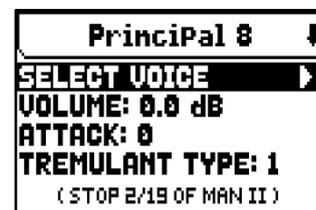
Una volta visualizzata la pagina VOICING, è possibile selezionare altri registri da modificare, utilizzando la bascula o il tirante nello stesso modo sopra descritto, oppure premendo il pulsante [^] per posizionare il cursore sul campo in alto, che riporta il nome del registro, ed utilizzando i pulsanti [+] e [-].
