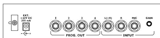
Nella parte posteriore dell'organo sono presenti diverse connessioni per il collegamento audio con impianti di diffusione esterni. Sono inoltre presenti un ingresso di linea stereo ed uno microfonico per l'utilizzo dell'amplificatore interno dell'organo.
