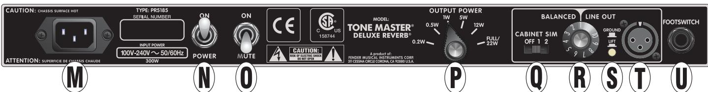
**M. GNAZDO ZASILANIA:** Podłącz dołączony przewód zasilania do uziemionego gniazdku elektrycznego zgodnie z wartościami napięcia i częstotliwości podanymi na etykiecie umieszczonej z boku gniazda. Zakres pracy to 100V–240V.
