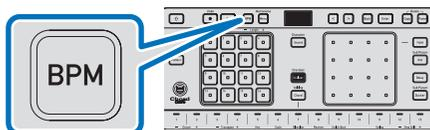
Il valore BPM viene visualizzato sul display dell'unità principale.
